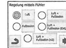
Die erwünschte Regelung ist mit der Betätigung der runden Taste neben dem Angebot der Regelungsmöglichkeiten mittels Fühler auszuwählen. Die aktive Taste ist rot.
