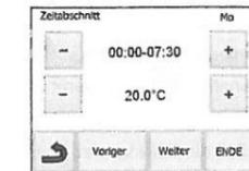
Die Taste „Weiter“ drücken und die Programmierung fortsetzen. Der nächste Zeitabschnitt beginnt am Ende des letzten. Der letzte Zeitabschnitt endet um 24:00 Uhr. Dann die Taste „Weiter“ drücken.
